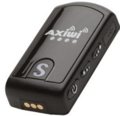
Das AXIWI Kommunikationssystem ist ein drahtloses Vollduplex-Intercomsystem. Fünf Personen können gleichzeitig drahtlos miteinander kommunizieren, also Hören und Sprechen wie beim Telefonieren, auf Wunsch auch mit PTT-Tastendruck wie beim Funken.
